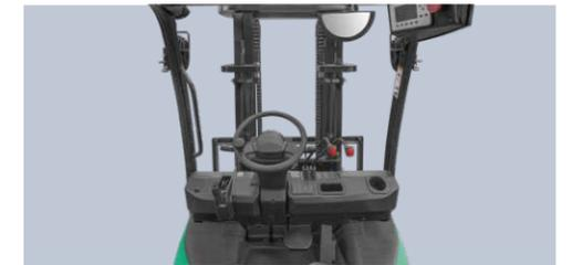
Das Weitsicht - Hubgerüst ist so orientiert, dass es die Sicht möglichst wenig behindert wird. Auch die verbreiterte Öffnung des Gabelträgers wirkt in diesem Sinn.
