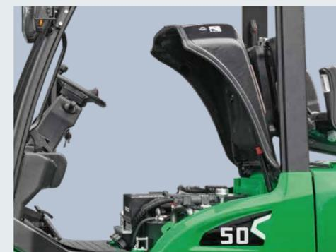
Die Haube ist mit einer von selbst einrastenden Gasfeder ausgestattet und lässt sich weit öffnen, so dass sich die Batterie einfach wechseln lässt, ohne die Finger einzuklemmen.
